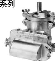
带阻火器的呼吸阀组提供呼吸压力排放, 并且可防止外部传入火焰的蔓延。适于 NEC 标准的 D 组 (IEC 标准的 IIA 组) 蒸汽。
